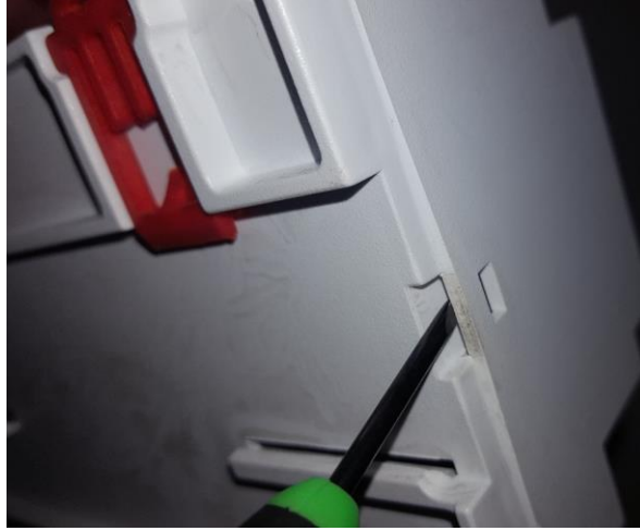
شکل ۵ روش صحیح باز کردن درب ماژول
